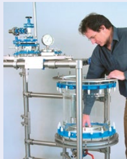
Swing-out mechanism for easy removal of the filter cake Ausschwenkmechanismus zur einfachen Entnahme des Filterkuchens
